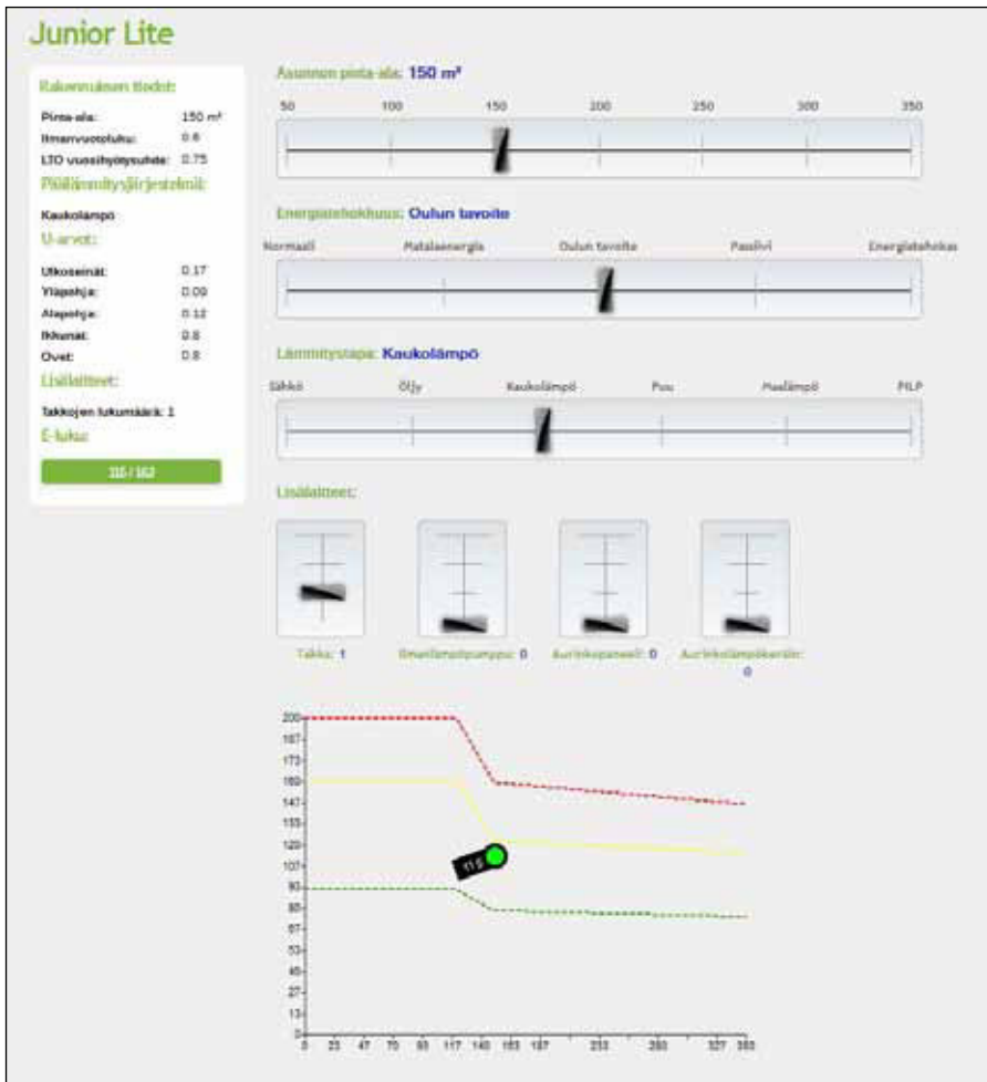
Kuva 3: Junior Lite –ohjelmalla ( https://www.energiajunior.fi/elukulaskuri ) voi iteroida energialaskentaa suunnitteluprosessin aikana. Liukukytkimillä valitaan rakennuksen koko ja – energiatehokkuus sekä lämmitysmuoto. Lisäksi valitaan tulisijojen määrä, ilmalämpöpumppu, aurinkokerääjien ja – paneelien pinta-ala. Ohjelma laskee alustavan E-luvun, jonka perusteella voidaan arvioida suunnitteluratkaisun energiatehokkuutta.
